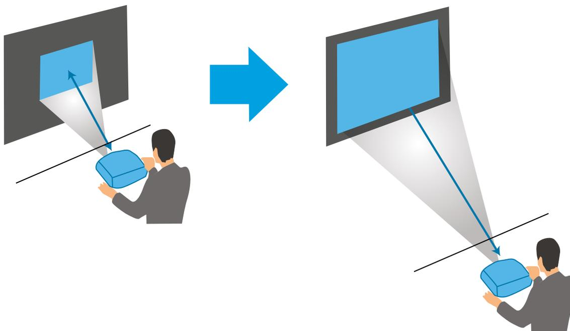
Расстояние от проектора до экрана определяет примерный размер изображения. Чем дальше проектор от экрана, тем больше изображение, но это также может варьироваться в зависимости от коэффициента масштабирования, аспектового отношения и других настроек.
